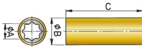
Für Wellendurchmesser (A) in mm und Aussenlagerdurchmesser (B) in Zoll. Länge (C) in mm.
